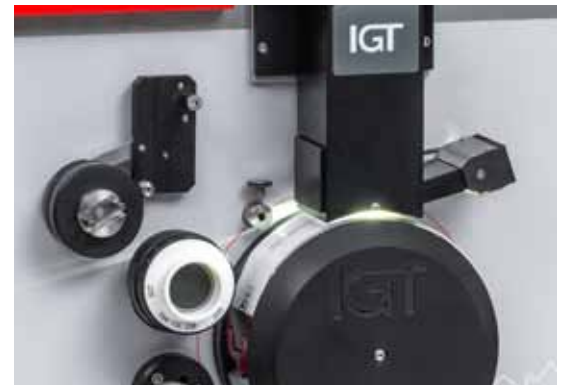
IGT Pick ISO 3783: die Kamera beim Scanvorgang
