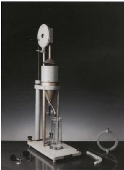
Das Mahlgradprüfgerät SR 1 dient zur Bestimmung der Entwässerungsgeschwindigkeit von Papier-, Holz- und Holzschleifstoffen.
