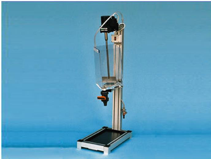
Das Verteilgerät entspricht in seiner Bauweise den Vorschriften der Einheitsmethode und dient speziell zur Mischung und Verteilung der Zellstoffsuspension für die Mahlgradprüfung sowie der Herstellung von Prüfblättern in Laborblattbildnern.
