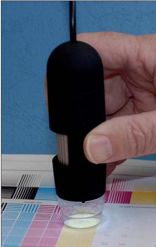
Das 68-86 DPM Digitale Taschenmikroskop ist ein tragbares Gerät zur Qualitätsanalyse. Es liefert gestochen scharfe, hochauflösende Farbbilder mit einer Auflösung bis zu 1280x1024 Pixel. Für spezielle Untersuchungen kann die integrierte LED-Beleuchtung ein- oder ausgeschaltet werden.
