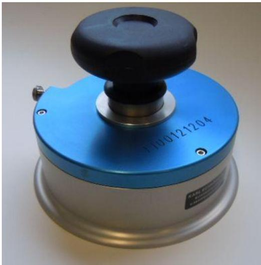
Nur ein Prüfling mit genau eingehaltenem Flächenmaß garantiert die zuverlässige Gewichtsbestimmung.
